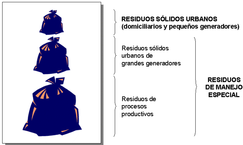
Figura 1. Distribución de residuos con características de residuos sólidos urbanos, en función del volumen de generación
